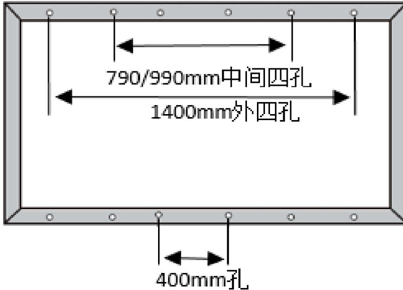
◇ 组件横梁垂直长边安装，组件横梁平行长边安装，跟踪支架安装（具体见下列安装方式图例），安全系数  $\gamma_m=1.5$  (测试载荷=设计值\*1.5 倍安全系数)。
